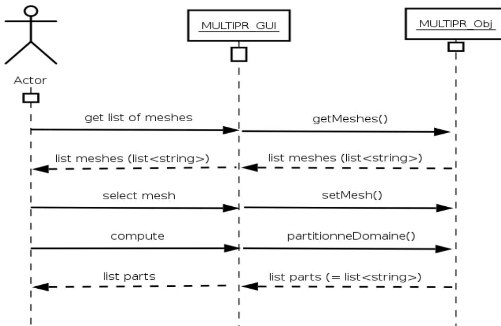
**Figure 4 : Diagramme de séquence : une échelle**
